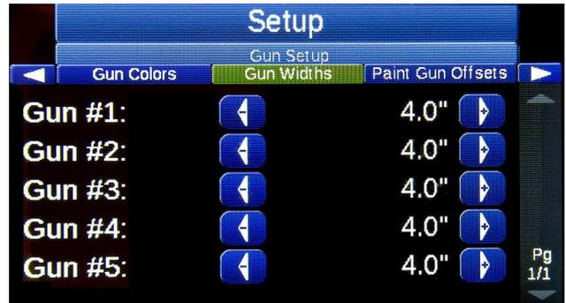
Ajuste la anchura de la pistola para que coincida con el ancho real de la aplicación del material en la carretera. Configurar correctamente la anchura de la pistola es importante para obtener precisión en los cálculos de grosor, el registro de datos y la impresión de informes.
